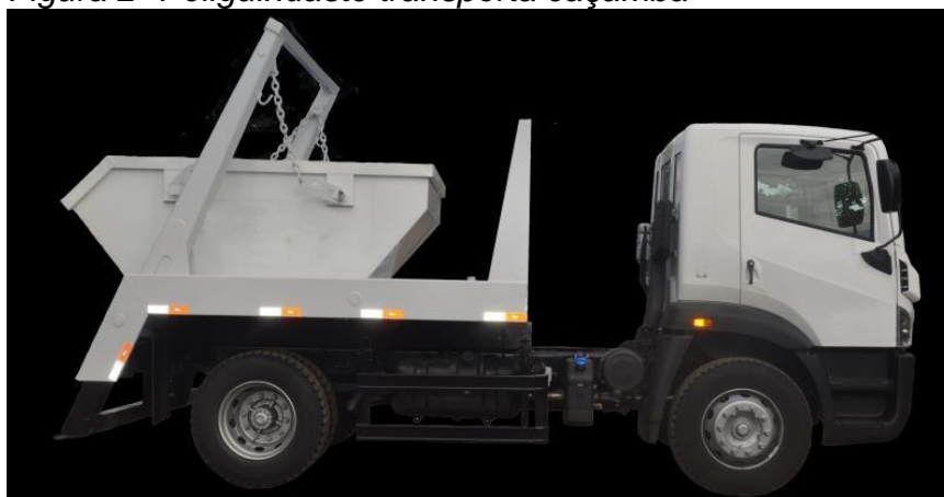
Figura 2- Poliguindaste transporta caçamba
